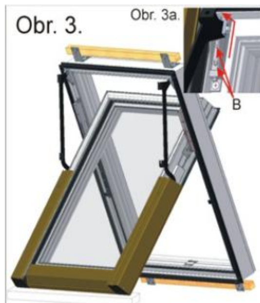
Po odstranění horní části oplechování uvolněte zajišťovací šrouby B a rozpojte kování, jak je nakresleno na Obr. 3a. Toto proveďte současně na levé i pravé straně. Vyjměte opatrně křídlo a položte ho na čistou a měkkou podložku. Odšroubujte horní a dolní dřevěnou lištu.
