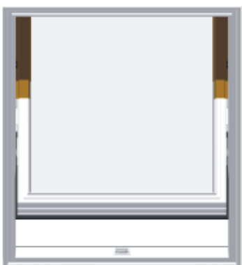
4. Pozice pro mytí, křídlo otočeno o 120°
