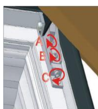
6. Regulace výšky položení křídla v rámu. A,B – přítlačné šrouby C – regulační šroub
